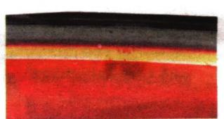
Von acht Zehnerpackungen rostet eine nach vier Monaten. Die Rohlinge sind nicht mehr zu retten, die äußeren Datenspuren beschädigt. Trockene Lagerung ist notwendig, um die Daten vorläufig zu sichern.
