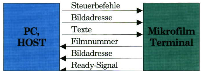
Abb. 13: Zwei-Weg-Kommunikation für den komfortablen Dialog zwischen DV und Speichermedium Mikrofilm.
